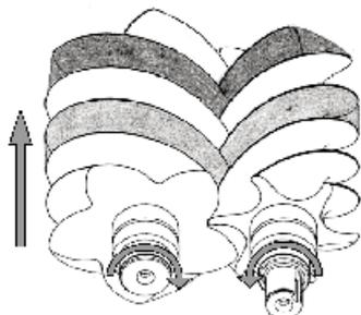
El tornillo macho y el tornillo hembra se engranan y giran en sentido opuesto en la cámara que contiene los orificios de aspiración y de impulsión.
