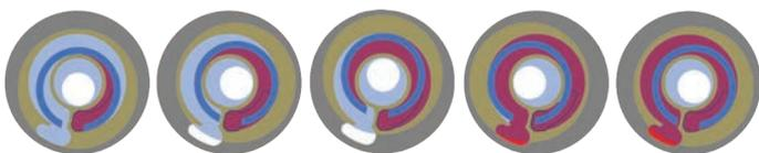
La velocità lineare differenziale tra il cilindro e il disco è bassa e uguale in qualsiasi punto del disco. Questo "movimento lento" richiede un consumo di energia inferiore rispetto alle pompe che hanno parti rotanti e che funzionano con una velocità periferica elevata.
