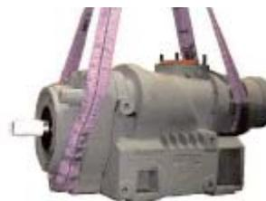
Les goujons de fixation des brides de refoulement peuvent être utilisés pour l'installation d'un anneau de levage permettant le transport du compresseur.
