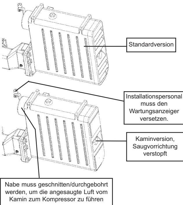
In diesem Fall erfolgt die Luftzufuhr zum Kompressor über die Rückseite des Filtergehäuses, auf der dazu vorgesehenen Nabe mit Durchmesser 140.
