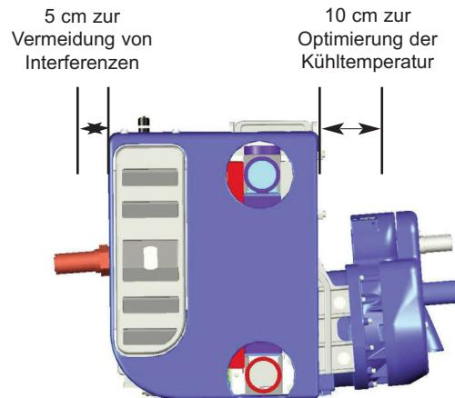
Es ist ebenfalls ein Mindestabstand von 5 cm zwischen allem Zubehör im Fahrgestell (NEBENABTRIEB, Kardanwelle...) und dem Aggregat einzuhalten.
