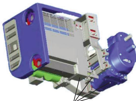
Zulässiger Auflagebereich zur Verkeilung des Aggregats. Bevorzugte Verkeilung unter Konsole oder Kompressor.
