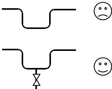
Falls die Installation begleitbeheizt ist, muss ein Ableiten der Ausdehnung in die Leitungen erfolgen können. Es ist daher notwendig, dass das Produkt in den Rohrleitungen vor dem in der Pumpe enthaltenen Produkt erwärmt wird. Es muss ebenfalls darauf geachtet werden, dass die zu erwärmende Pumpe nicht durch geschlossene Ventile abgesperrt ist.
