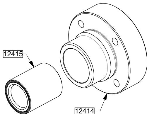
Den Ring 12415 mit Hilfe eines Abziehers vom Frontdeckellager 12414 entfernen.
