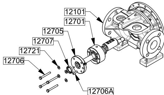
Gegebenenfalls die Lippendichtung 12707 (Lippe nach außen gerichtet) im Lagerdeckel 12705 montieren.
