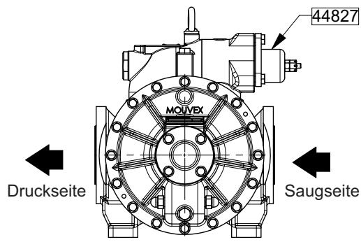
Diese Kontrolle ist für ein doppeltes Überströmventil nicht notwendig, da die Pumpe in diesem Fall in beiden Betriebsrichtungen abgesichert ist.
