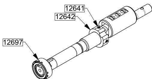
Den Oberflächenzustand der Welle 12501 überprüfen, im Fall von Kratzern rechts vom O-Ring des drehenden Teils der Gleitringdichtung mit feinem Schleifpapier bearbeiten. Es sollte besonders auf parallel zur Wellenachse verlaufende Kratzer geachtet werden, die unbedingt vermieden werden müssen.
