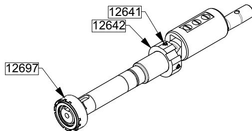
Die Welle 12501 (Mitnehmer-Ring 12641 und seine Schrauben 12642) vom rotierenden Gleitring 12697 abziehen. Dabei nicht zerkratzen!
