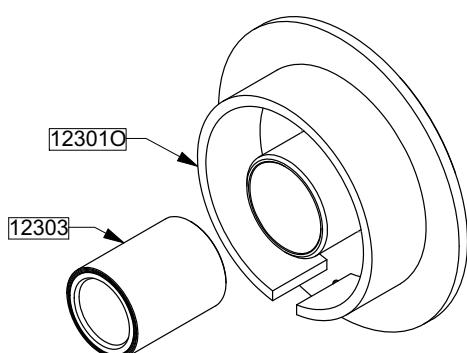
Den Ring 12303 mit Hilfe einer Presse und eines Zylinderstücks vom Kolben 12301O abziehen.
