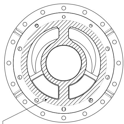
Auftragsfläche für das Dichtungsmittels
