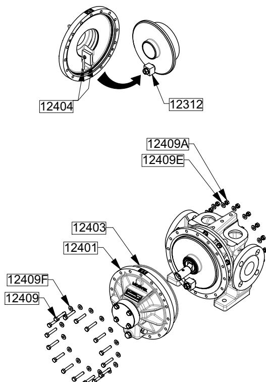
Den Dichtungssitz 12403 reinigen.
