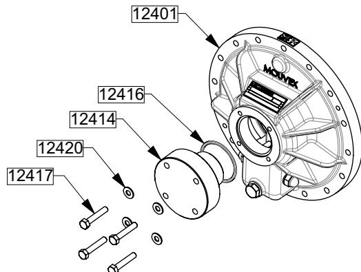
Den Dichtungssitz 12416 reinigen.
