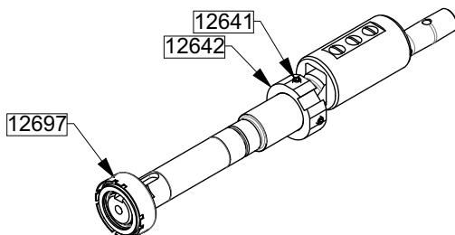
Quitar la cara giratoria 12697 (el arrastre de junta 12641 y sus tornillos 12642) del eje 12501 cuidando de no rayarlo.
