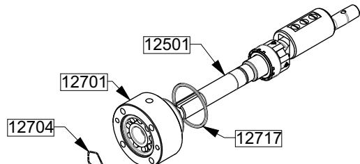
Montar el conjunto caja de rodamiento (12701, 12703, 12733, 12627 y la contrapartida fija del cierre mecánico) en el eje 12501.
