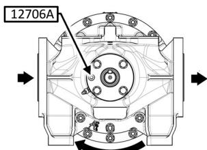
El tornillo 12706A debe estar en el lado aspiración. Esta posición asegura una mejor recirculación interna del producto, evitando un aumento de temperatura. Sin embargo, conlleva una menor capacidad de autocebado y puede significar una disminución del caudal, en particular, en productos de baja viscosidad. **Consúltenos ante cualquier dura relativa a esta configuración.**
