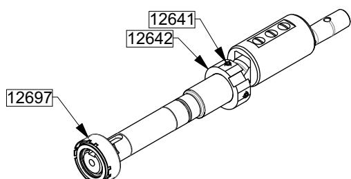
Controlar el estado de la superficie del eje 12501, pasarle una lija fina en caso de rayas perpendiculares a la junta tórica de la cara giratoria del cierre. Se deberá prestar una atención particular a las rayas paralelas a la línea del eje, que deben evitarse imperativamente.
