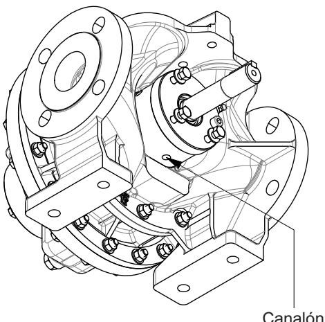
Colocar los tornillos 12706 y las nuevas arandelas cónicas estriadas 12721 con fijatornillos medio.
