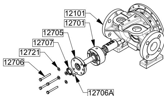
Si fuera necesario, colocar el retén labial 12707 con el labio orientado hacia el exterior en la tapa de rodamiento 12705.
