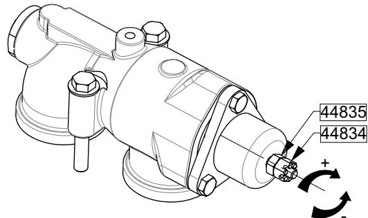
El ajuste es satisfactorio cuando el caudal corresponde al esperado y cuando el motor soporta, sin incidentes, el aumento de potencia debido a la sobrepresión durante el cierre de la descarga. Según la información proporcionada al Servicio técnico, de este modo se ajustan los bypass de nuestros grupos de motobombas o bombas eléctricas.
