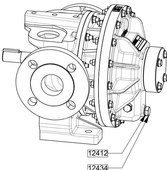
Una vez vaciada la bomba, colocar el tapón 12434 y su junta 12412.
