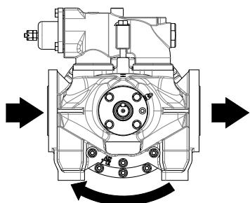
Sólo se debe invertir el sentido de rotación después de que la bomba se haya detenido completamente.
