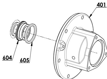
L'introduction de la contrepartie 604 et son joint 605 au fond de l'alésage se fait à la main, jusqu'en butée. La partie tournante 697 peut être utilisée afin d'éviter de rayer la face de friction. Sinon utiliser un chiffon propre et doux.
