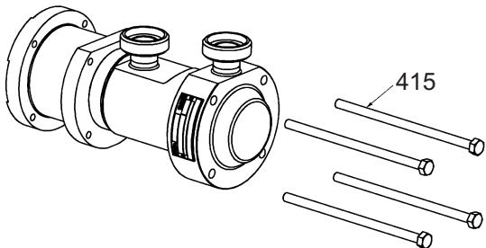
E' importante tenere ben fermo il cilindro durante lo smontaggio del coperchio. Una trazione o torsione esercitate sul cilindro possono causare il danneggiamento del soffietto.
