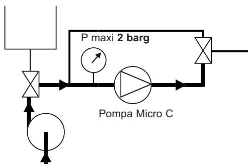
È preferibile non far girare la pompa Micro C durante il NEP, sebbene una bassa velocità di rotazione (<100 rpm) è accettabile in condizioni alternate di marcia ed arresto.
