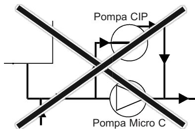
In effetti, in questo caso, la pressione all'aspirazione della pompa Micro C è inferiore a quella di mandata, ed il pistone rimane forzato nel cilindro. Perciò la pompa Micro C non permette il passaggio. La sua efficienza di pulizia non può essere garantita, e la coppia pistone / cilindro si userà prematuramente.
