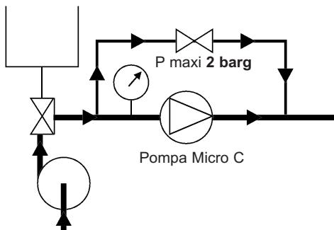
È preferibile non far girare la pompa Micro C durante il NEP, sebbene una bassa velocità di rotazione (<100 rpm) è accettabile in condizioni alternate di marcia ed arresto.
