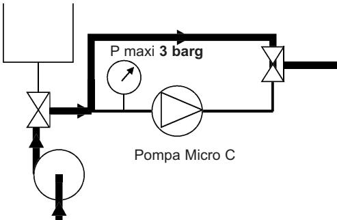
La pompa non deve assolutamente ruotare durante questa operazione.
