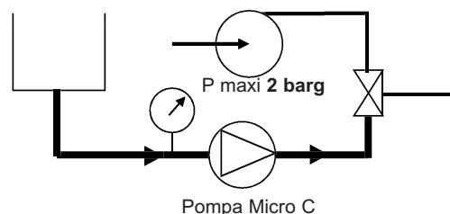
Raccomandiamo di limitare la velocità di rotazione della pompa Micro C.
