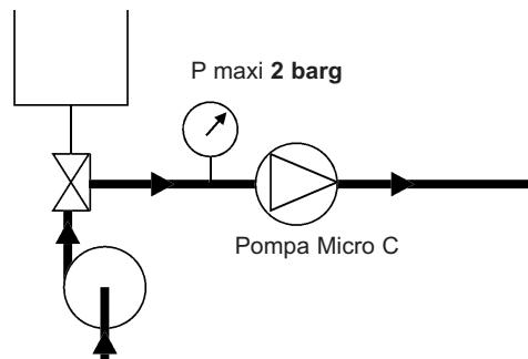
È preferibile non far girare la pompa Micro C durante il CIP, sebbene una bassa velocità di rotazione (<100 rpm) è accettabile in condizioni alternate di marcia ed arresto.
