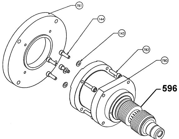
Lo smontaggio del pignone va effettuato smontando il fondo e la tubatura come indicato nel § SMONTAGGIO.
