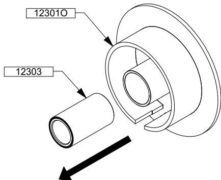
Retirer la bague 12303 du piston 12301O à l'aide d'une presse et d'un cylindre.
