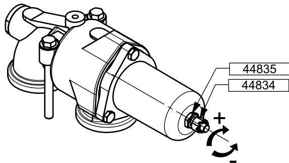
Le réglage est satisfaisant lorsque le débit est conforme au débit prévu et lorsque le moteur supporte sans incident l'augmentation de puissance due à la surpression lors de la fermeture du refoulement. C'est ainsi que sont réglés, en fonction des renseignements fournis au Service Technique, les bipasses de nos groupes motopompes ou électropompes.
