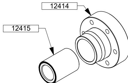
Orienter le chanfrein de la bague côté extérieur (voir schéma ci-dessus).
