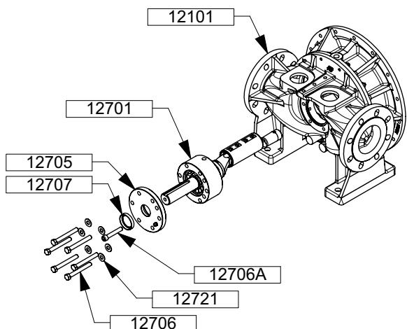
Le cas échéant, monter le joint à lèvre 12707, lèvre orientée vers l'extérieur dans le couvercle de roulement 12705.
