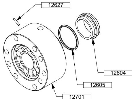
Le cas échéant, nettoyer le roulement 12703 de sa graisse.
