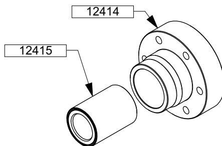
**Bague carbone :** Détruire la partie carbone de la bague 12415 à l'aide d'un maillet et d'un burin en prenant soin de ne pas endommager le coussinet de fond 12414. Retirer la partie métallique de la bague 12415 à l'aide d'un extracteur.
