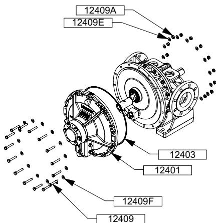
Retirer les boulons de fond (vis 12409, écrous 12409A et rondelles 12409E - 12409F).
