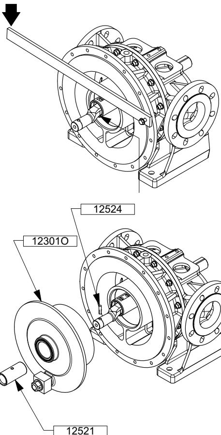
Lubrifier les faces de frottement du piston 12301O avec un produit compatible avec le liquide pompé.
