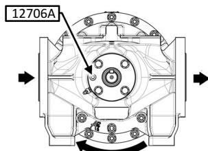
La vis 12706A doit se trouver côté aspiration. Cette position assure une meilleure recirculation interne du produit évitant une montée en température. Elle entraîne en revanche une moindre capacité d'auto-amorçage et peut conduire à une diminution du débit, notamment sur produits de faible viscosité. **Nous consulter pour toute question concernant cette configuration.**
