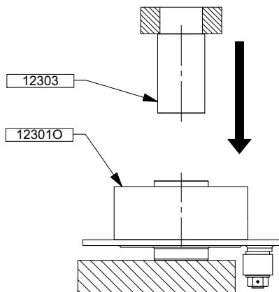
Insérer la bague 12303 dans le piston 12301O à l'aide d'une presse et d'un cylindre jusqu'à ce que les faces de la bague et du piston soient alignées (d'un côté ou de l'autre).
