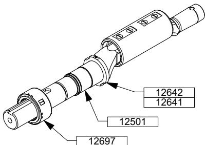
Retirer la partie tournée 12697 (l'entraîneur de garniture 12641 et ses vis 12642) de l'arbre 12501 en veillant à ne pas le rayer.
