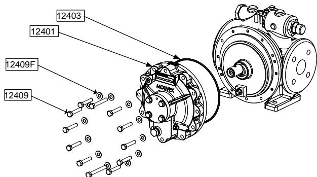
Den Dichtungssitz 12403 reinigen.
