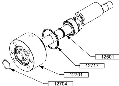
Die Einheit Lagergehäuse (12701 - 12703 - 12731 - 12733 - 12627 und stehenden Gleitring der Gleitringdichtung) auf die Welle 12501 montieren
