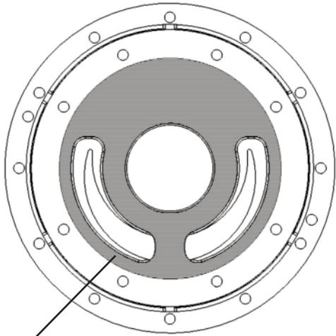
Auftragsfläche für das Dichtungsmittel
