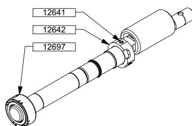
Den Oberflächenzustand der Welle 12501 überprüfen, im Fall von Kratzern rechts vom O-Ring des drehenden Teils der Gleitringdichtung mit feinem Schleifpapier bearbeiten. Es sollte besonders auf parallel zur Wellenachse verlaufende Kratzer geachtet werden, die unbedingt vermieden werden müssen.
