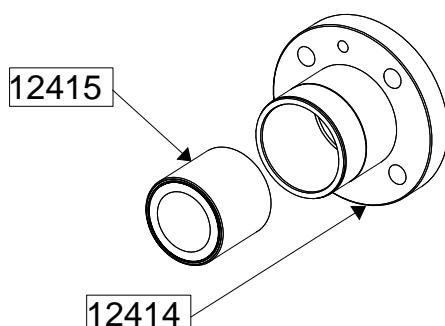
Den Ring 12415 mit Hilfe eines Abziehers vom Frontdeckellager 12414 entfernen.
