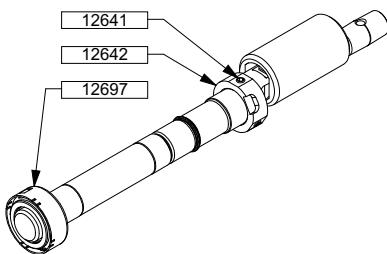
Die Welle 12501 (Mitnehmer-Ring 12641 und seine Schrauben 12642) vom rotierenden Gleitring 12697 abziehen. Dabei nicht zerkratzen.
