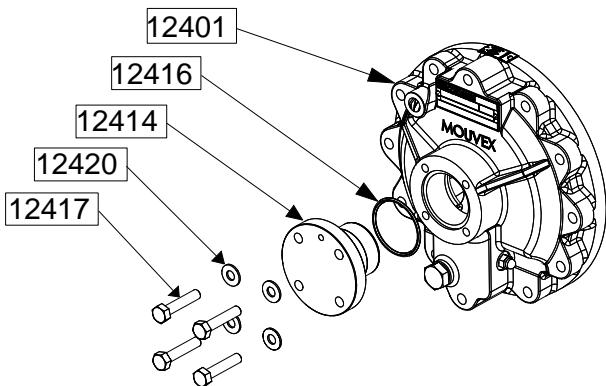
Den Dichtungssitz 12416 reinigen.
