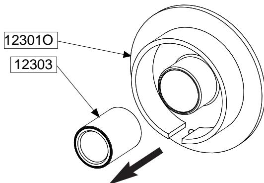
Den Ring 12303 mit Hilfe einer Presse und eines Zylinderstücks vom Kolben 12301O abziehen.
