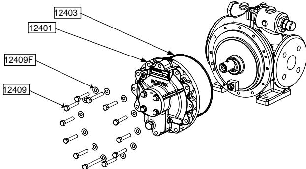
Die Schrauben des Gehäusedeckels (Schrauben 12409, 12409D und 12409G und Scheiben 12409F) entfernen.
