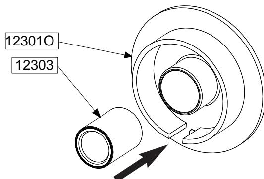
Die Buchse 12303 mit Hilfe einer Presse und eines Zylinderstücks in den Kolben 123010 drücken, bis die Seiten der Buchse und des Kolbens fluchten (auf beiden Seiten).
