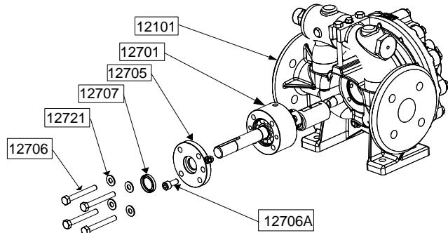
Gegebenenfalls die Lippendichtung 12707 (Lippe nach außen gerichtet) im Lagerdeckel 12705 montieren.
