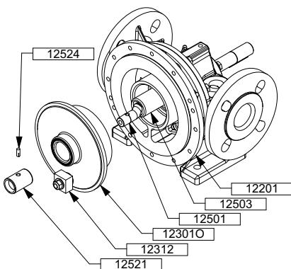
Die Kontaktflächen des Kolbens 12301O mit einem Mittel schmieren, das mit der gepumpten Flüssigkeit kompatibel ist.
