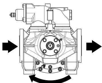
Die Umkehr der Drehrichtung darf nur nach einem kompletten Stopp der Pumpe erfolgen.
