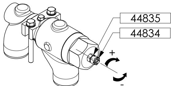
Die Einstellung ist richtig, wenn die Fördermenge der vorgesehenen Menge entspricht und wenn der Motor den beim Schließen des Druckkreises entstehenden Überdruck und den damit verbundenen Belastungsanstieg ohne Probleme verkraftet. Auf diese Weise werden die Überströmventile unserer Pumpenaggregate entsprechend Informationen des Technischen Kundendienstes eingestellt.
