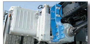
Direkt getriebenes, ungekühltes System
