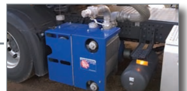
(Saugen + Druck) Direkt getriebenes, gekühltes (SP) Saug- und Drucksystem
