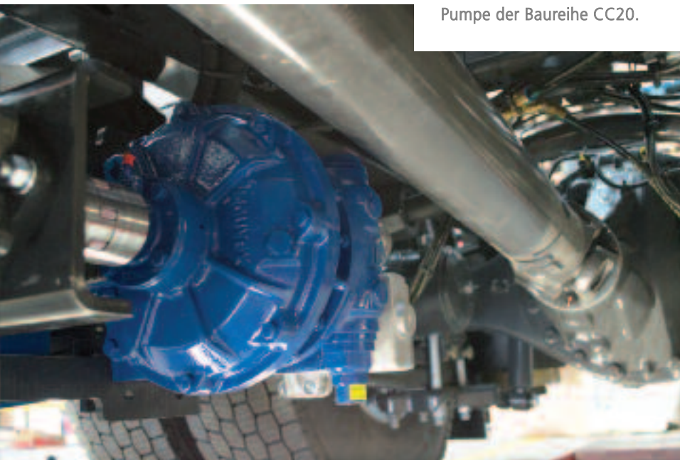
Ergebnis einer intensiven (Weiter-)Entwicklung: Enterprise-Series-Vane-Kompressor (I.) mit Hydrive-Hydraulic-Cooler-Konzept.
