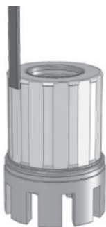
Установка магнитных сегментов
