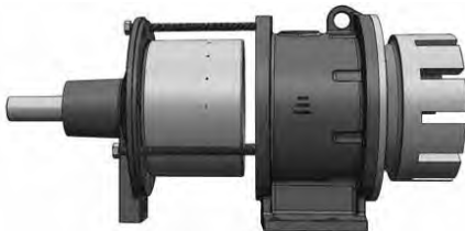
Разделение сочленения с помощью нажимных винтов
