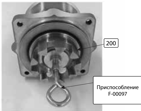
Приспособление, вставленное в узел ротора
