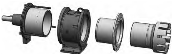
Извлечение ротора и защитной оболочки
