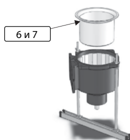
Вставка защитной оболочки и опорной пластины
