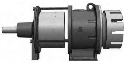
Disaccoppiamento con martinetti a vite
