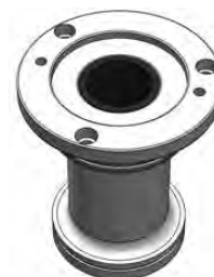
Instalar el casquillo radial frontal
