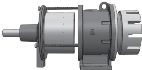
Kupplung mit Abdrückschrauben trennen
