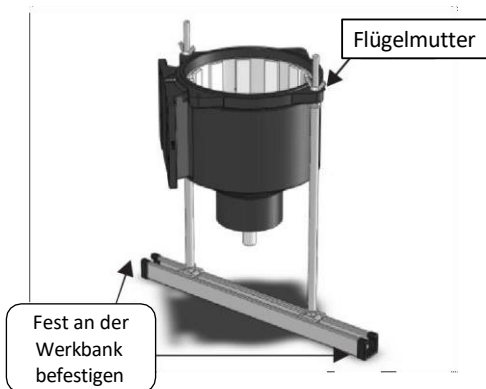
ÄUSSERE ANTRIEBSBAUGRUPPE, DIE AM WERKZEUG MONTIERT IST
