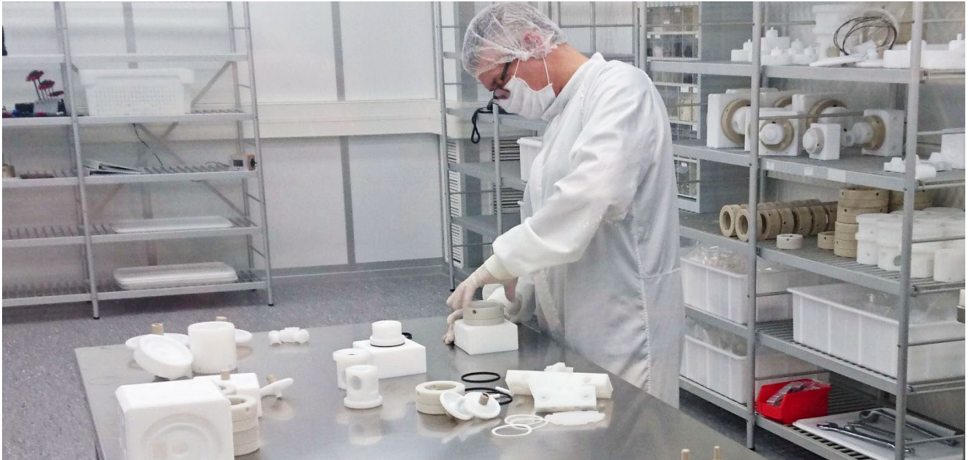
Jede Komponente der Almatec® FUTUR-Serie wird mehrfach gereinigt und unter Reinraumbedingungen gemäß ISO-Klasse montiert, um eine kontaminationsarme und reproduzierbare Leistung sicherzustellen. Ein konsequentes Reinigungs- und Montagekonzept trägt dazu bei, Variabilität zu reduzieren und die Eignung für Reinraumprozesse langfristig abzusichern.
