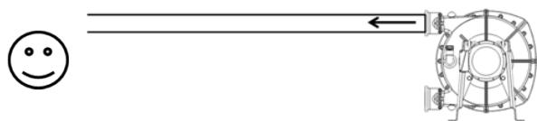
Dans le cas d'une installation avec tuyaux flexibles il est impératif de maintenir ou d'attacher ces derniers afin d'éviter le fouettement lors de la mise en pression de l'installation ou de limiter le trajet en cas de rupture d'un flexible.
