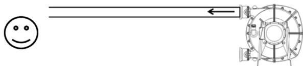
En el caso de una instalación con mangueras flexibles, es imperativo soportarlas o sujetarlas para evitar el batido de las mismas al presurizar la instalación o para limitar el alcance en caso de rotura de una manguera.
