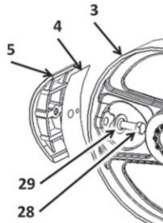
En el buje de rueda 19, aflojar todos los tornillos. Poner cinco tornillos en los agujeros de extracción para desbloquear el buje.
