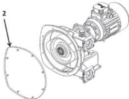
Schrauben 33 mit ihren Scheiben 34 anschrauben und anziehen, indem oben begonnen wird, um den Deckel zu sichern. **Anzugsdrehmoment 1 + 0,2 N.m.**
