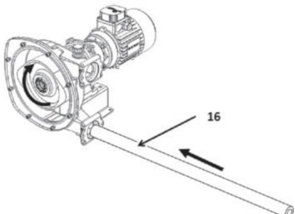
Wenn die Pumpe gegen den Uhrzeigersinn arbeitet, ist der Saugstutzen oben :
