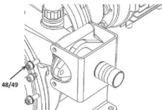
3. Sicherungsring 24 montieren.
