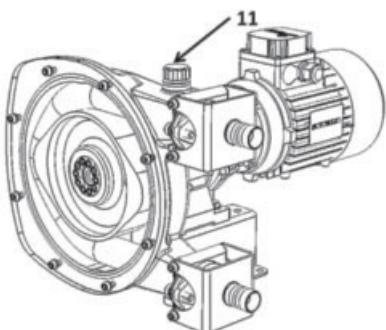
Gemäß Pumpentyp Schmiermittelmenge einfüllen :
