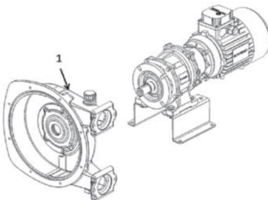
Wellendichtung 26 vom Pumpengehäuse abnehmen. Eine neue Wellendichtung 26 auf das Pumpengehäuse aufsetzen.
