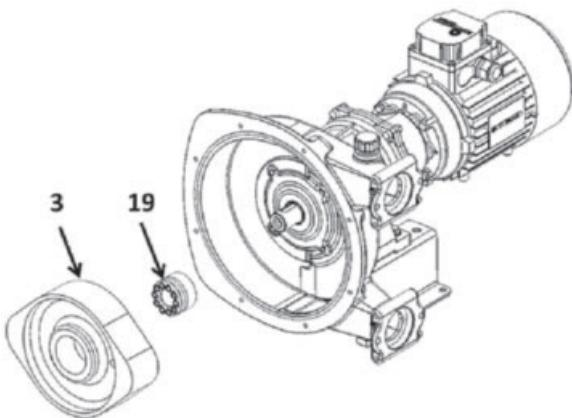
Den Rotor 3 so platzieren, dass der Abstand B zwischen der Außenseite des Rotors und dem Gehäuse 1 eingehalten wird.
