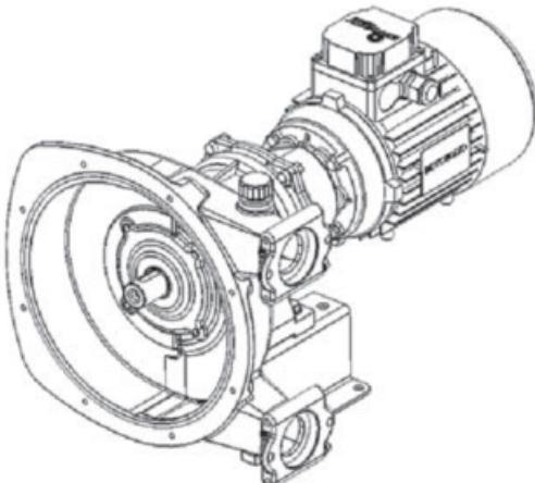
Falls die Wellenhülse 27 ausgetauscht werden muss, einen Hammer und einen Meißel verwenden, um die Hülse 27 zu zerbrechen und zu entfernen.
